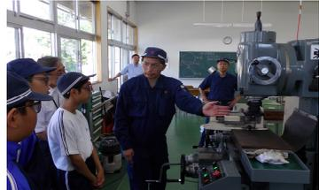
【図2】文鎮の製作(コンピュータで図面作成、フライス盤で加工)
