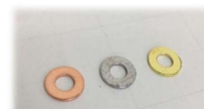
銅に亜鉛めっきを施して、 真鍮に加工
