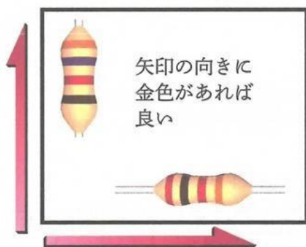
図2 炭素被膜抵抗器の取り付け向き
