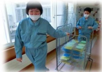
↑ すいた紙を乾燥棚に並べ、乾燥させます。この後、製品に加工します。
