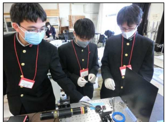
実験③ 溶着した光ファイバー を実験台に取り付け
