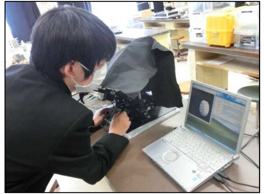
実験④ 錠剤に当てるレーザー光の角度調整
