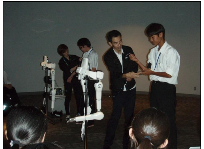
センサー部を腕に取り付け動かしているところ
