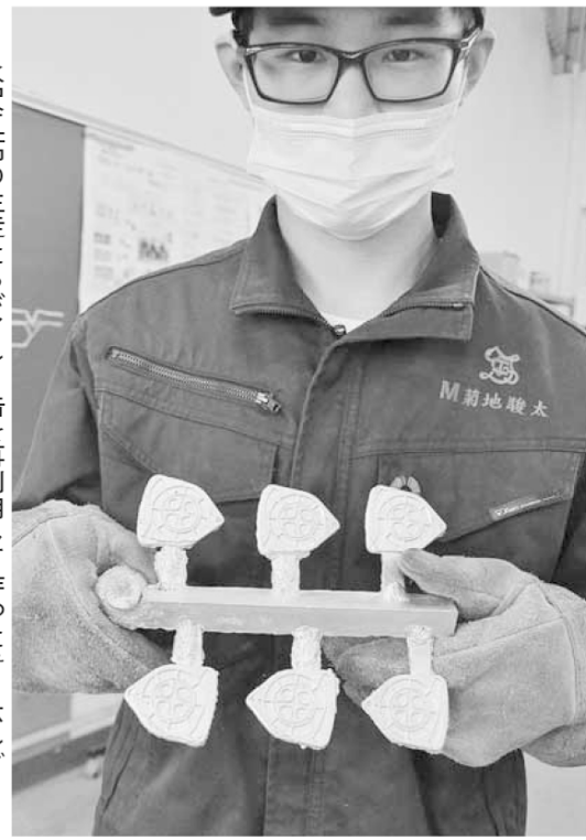
水沢工高の生徒たちがアルミ缶を再利用して作ったキーホルダー
