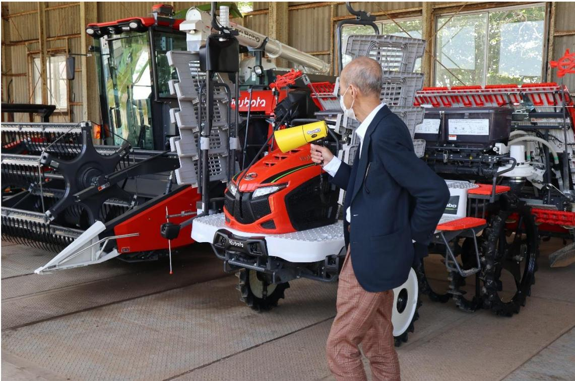
スマート農業用に開発された Agri Robo.自動運転アシスト機能が付いています。通常の農機具の 1.5 倍の価格になるとか。お話では左側のコンバイン型で 2000 万円弱ぐらいの値段になります(推定)。農地は5Gで位置情報が補正されて数センチ単位の精度で自動運転出来るそうです。ただしコンバインの方は草の中に人がいる可能性があり、それを感知するセンサーがないので、補助的に人が同乗しないと運転できないそうです。
