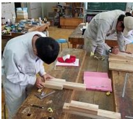
左、上 フラワースタンドの製作。墨付け作業を行い(左)、角鑿盤でほぞ穴を開けています(右)。
