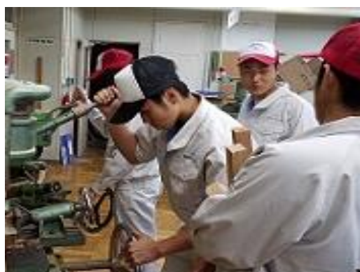
左、上 フラワースタンドの製作。墨付け作業を行い(左)、角鑿盤でほぞ穴を開けています(右)。
