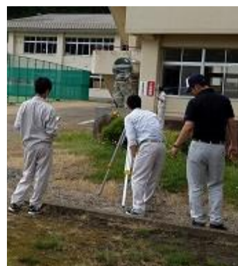
レベルという機器を使って高低差を測る水準測量を行っています。
