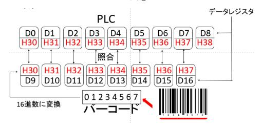
PLC内にDOからD16のデータレジスタを作成します。PLCがRUN状態になった際にDOからD8にOから8までの数値が格納されます。そしてバーコードを読み取った際にD9からD16にバーコードの8桁の数値を格納します。今回はASCIIコード表を用いて数値を16進数変換し、H30のように表示する。
