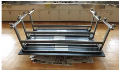
ベニヤと角材を仮止めし、同じ大きさのパネルを重ねて、机やブロックをおもりにして圧着します。
